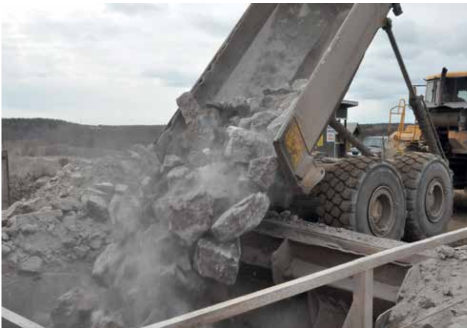
Сброс горной массы в дробильную камеру
